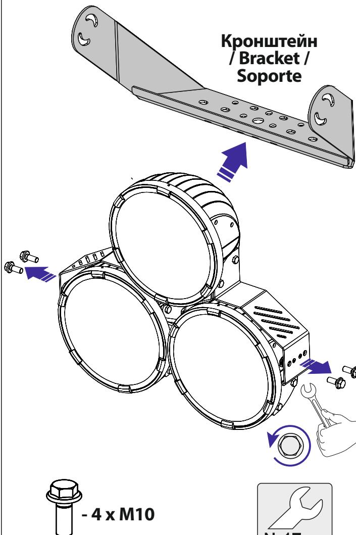
**Установите** поворотный кронштейн на монтажную поверхность и закрепите его, используя отверстия в кронштейне, с помощью винтов, болтов, анкеров (в комплект не входят) /
