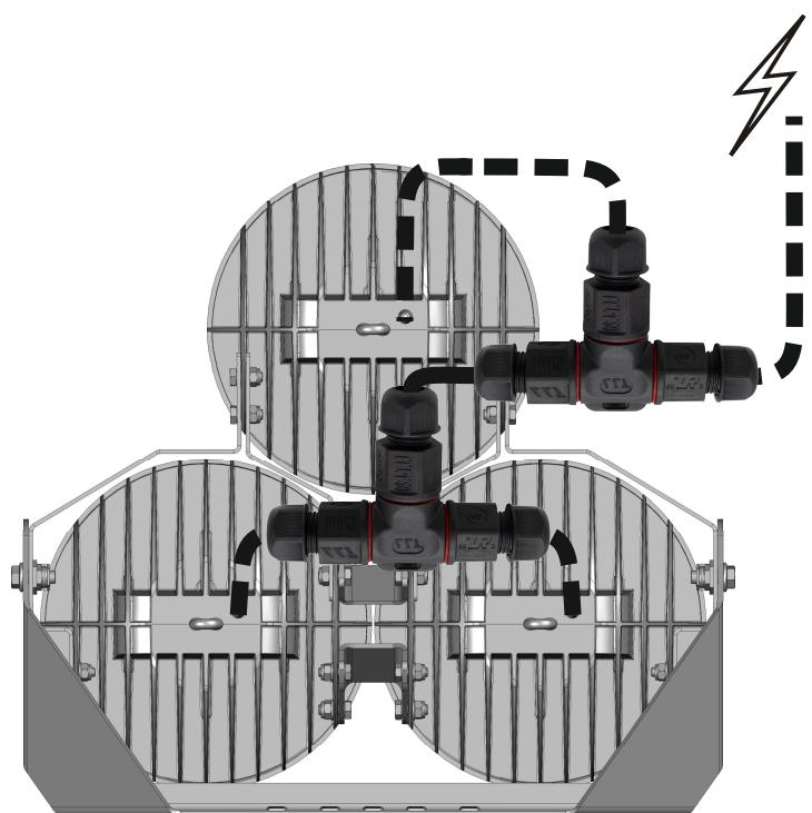
**Схема подключения** светильника с
